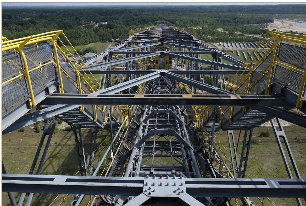
Obrázek 3: Těžký nadzemní dopravník v Lichterfeldu v Německu, Besucherbergwerk F 60. 18
